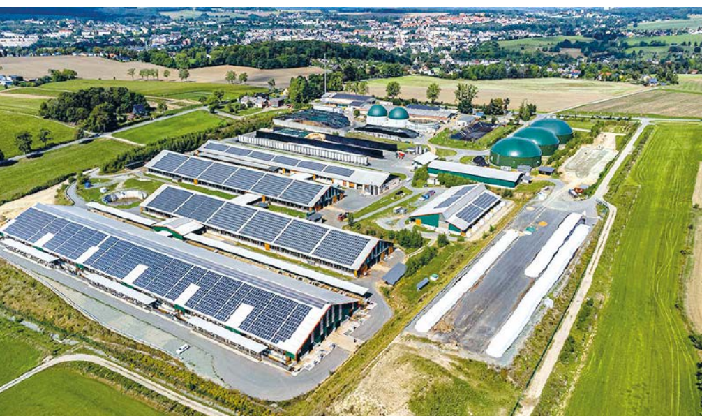
Abb. 1: Im März 2024 nahm die Agrar GmbH Reichenbach ihre Kumac Gärrestauffbereitung in Betrieb. Zusätzlich zur Milchviehanlage betreiben die Landwirte des Agrarunternehmens seit 2006 eine Biogasanlage mit einer elektrischen Leistung von 845 kW.
