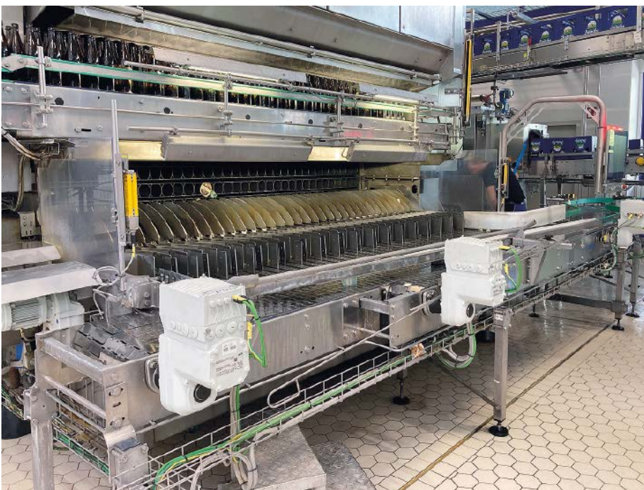
Abb. 5: Die Reinigungsmaschine Lavatec hat dank ihrer durchdachten Konstruktion und kontinuierlichem Schmutzaustrag einen sparsamen Wasser- und Energieeinsatz. Auch das Zuföhrband für den schonenden Transport der Flaschen wird durch energieeffiziente Antriebseinheiten Movigear performance angetrieben.
