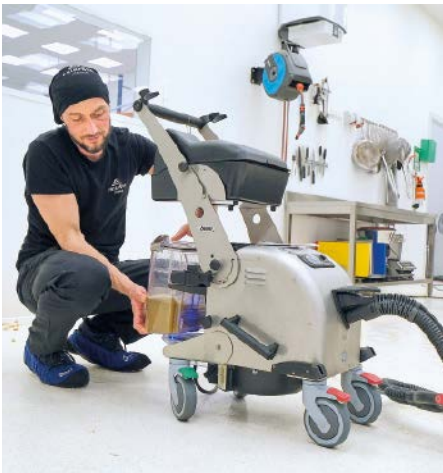
■ Abb. 2: Der gelöste Schmutz landet im Wasserfilter und wird einfach ausgeleert.
