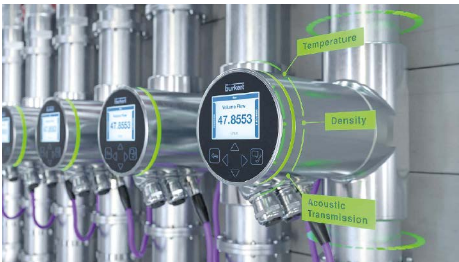
■ Abb. 3: Kontinuierliche, wartungsfreie Durchflussmessung: Der Sensor arbeitet nach dem patentierten SAW-Verfahren (Surface Acoustic Waves). Das vermeidet hygienekritische Einbauten und Verengungen sowie Toträume im Messrohr.
