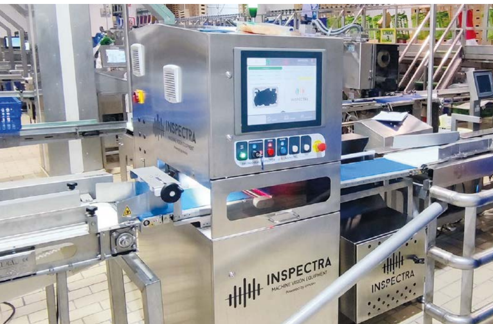
Abb. 1: Der Thermoseal & Label Inspector entwickelt vereint anspruchsvolle Technologien wie Hochgeschwindigkeits- und Verarbeitungserfassung mit der Inspectra HSP-Technologie, hyperspektraler Bildverarbeitung, Deep Learning und Leistungsstärke im Rot-Grün-Blau-Farbraum (RGB).
