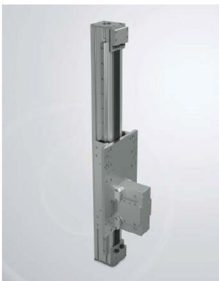
■ Abb. 5: Die Linearachsen der Modline-Serie ZCH garantieren dank des kugelumlaufgeführten Doppelschienensystems mit vier Führungswagen eine hohe Steifigkeit und Tragfähigkeit.
