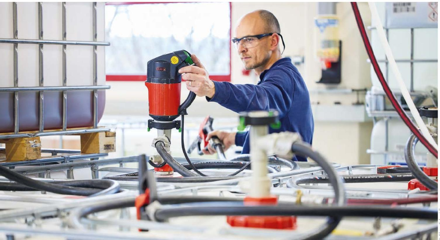
■ Abb. 1: Die einzelnen Mischungskomponenten werden in 1.000 l IBC oder 200 l Fässern angeliefert und müssen dann nach Rezeptur portioniert werden.
