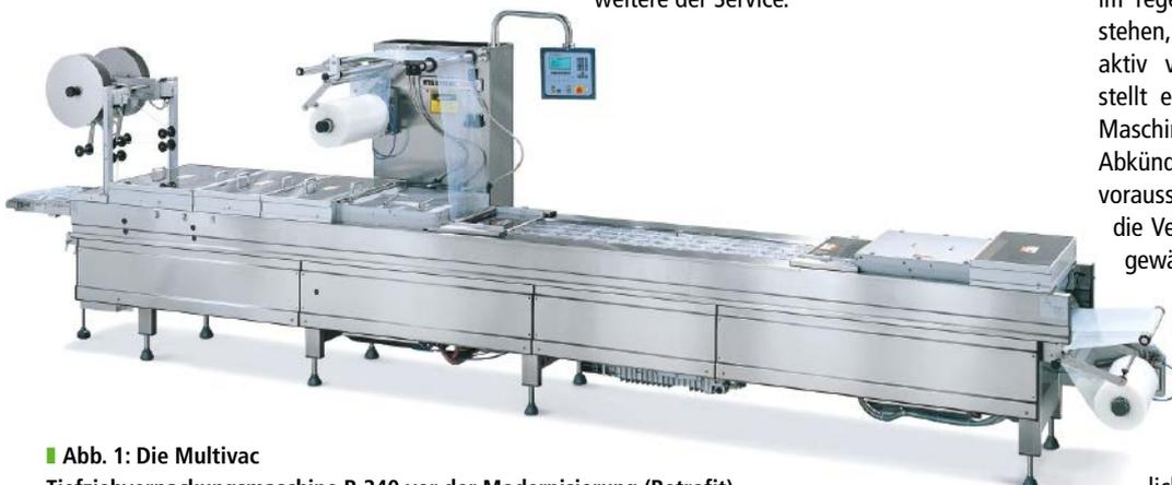
■ Abb. 1: Die Multivac Tiefziehverpackungsmaschine R 240 vor der Modernisierung (Retrofit).
