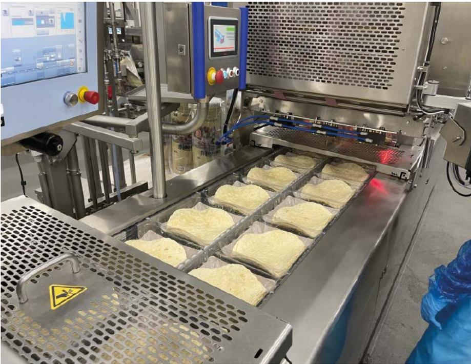
■ Abb. 2: Tortilla-Wraps werden sicher vakuumverpackt.
