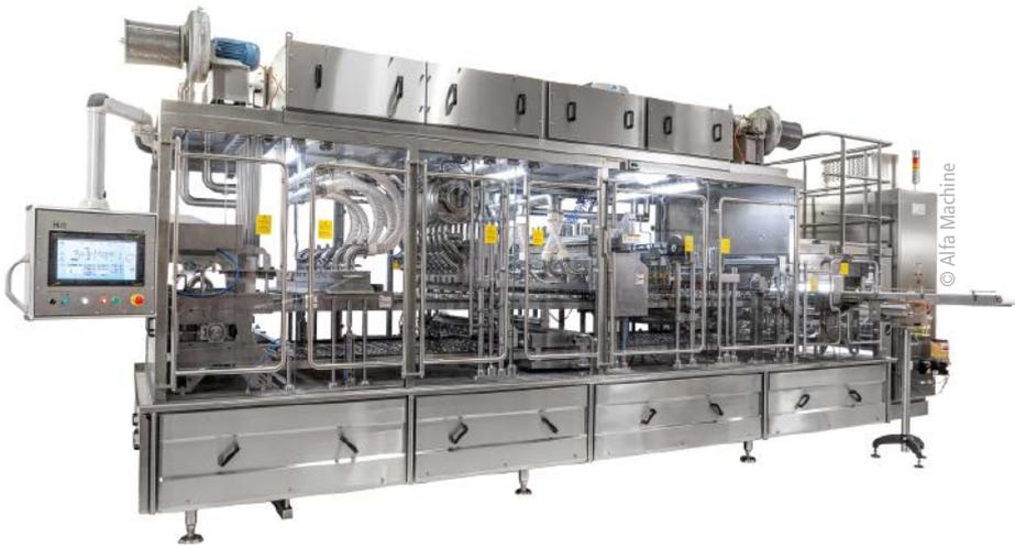
■ **Abb. 2:** Form-Fill-Seal-Maschine für Molkereiprodukte.
