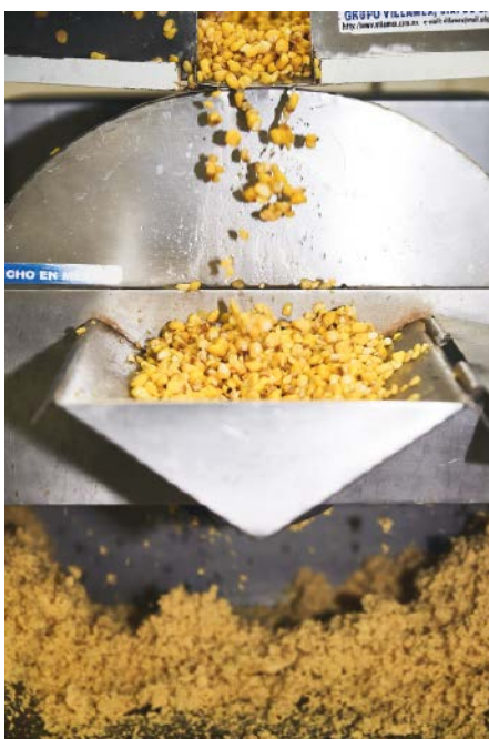
■ Abb. 3: Masamühle. In der Nixtamalisierung kocht und ziehen ganze Maiskörner in Wasser mit Kalziumhydroxid. Nach dem Mahlen des Nixtamals wird der Mais zu Teig (Masa) verarbeitet und auf gusseisernen Platten (Comales) über Feuer gebacken.
