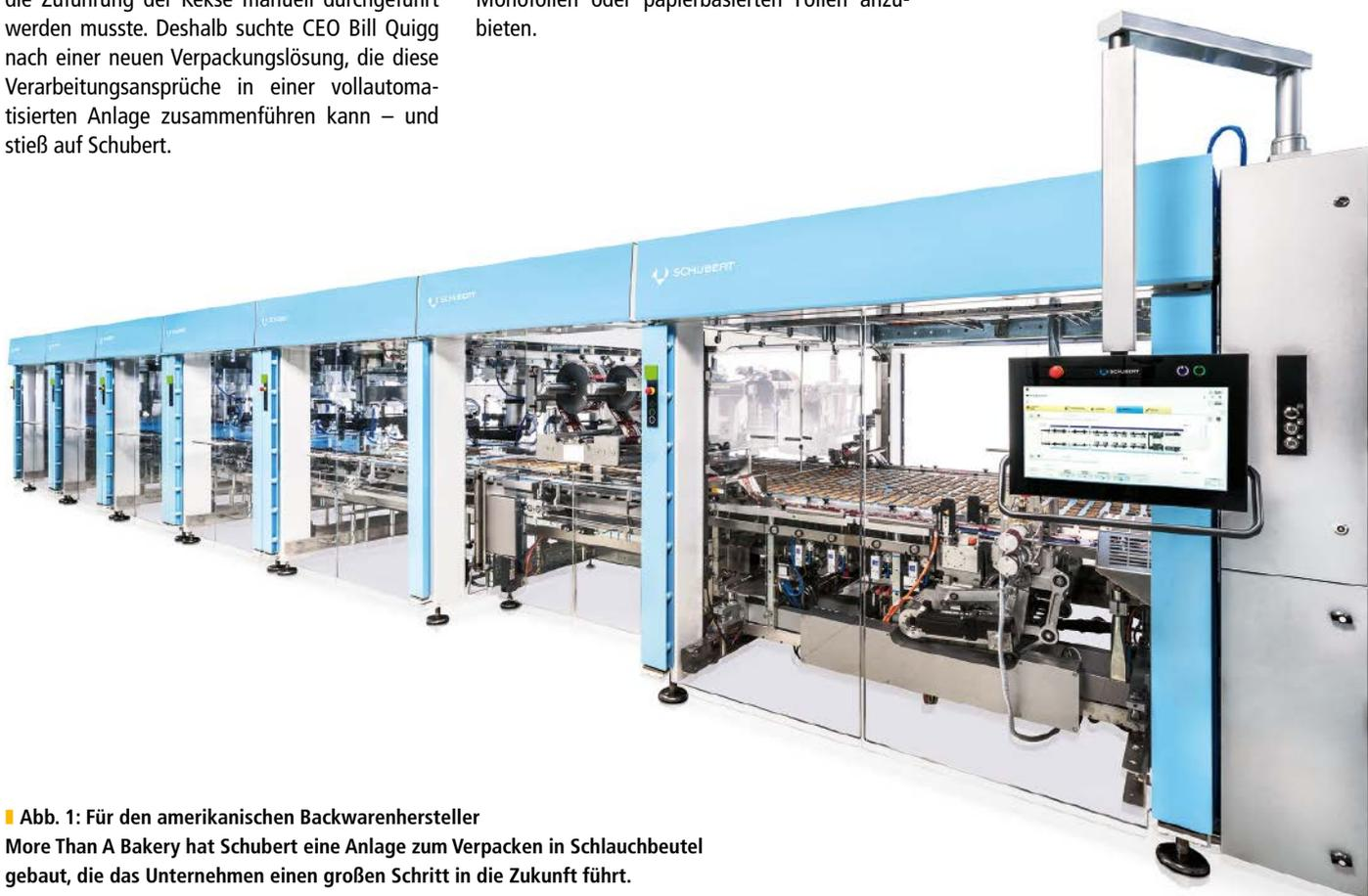
■ Abb. 1: Für den amerikanischen Backwarenhersteller More Than A Bakery hat Schubert eine Anlage zum Verpacken in Schlauchbeutel gebaut, die das Unternehmen einen großen Schritt in die Zukunft führt.
