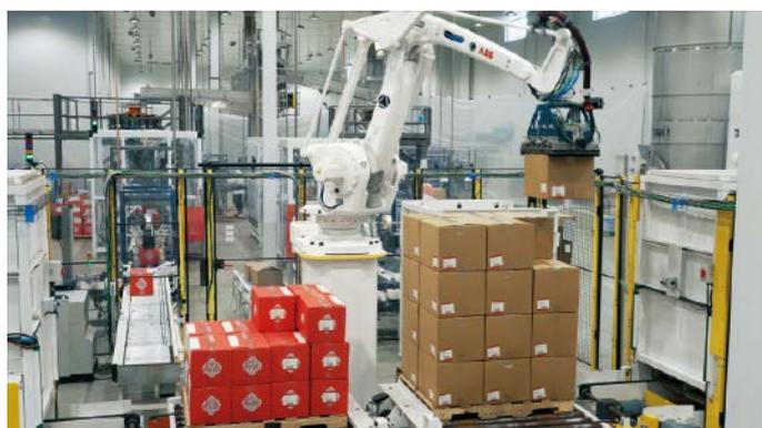
■ **Abb. 4:** Der Palettierroboter IRB 660 von ABB nimmt abwechselnd Kartons von jedem Förderband auf und baut parallel separate Paletten für jede Produktgröße.
