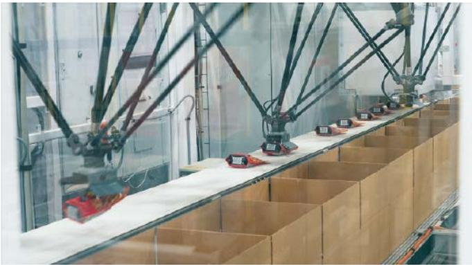
■ **Abb. 2:** Die zwei parallele Verpackungslinien bei Dot's sind mit drei ABB-Deltarobotern vom Typ IRB 360 Flexpicker für die kleineren Tüten sowie zwei Flexpickern für die Größeren bestückt. Die Deltaroboter nehmen die Verpackungen von einem Förderband und platzieren sie mit unterschiedlichen Vakuumgreifern in Kartons.
