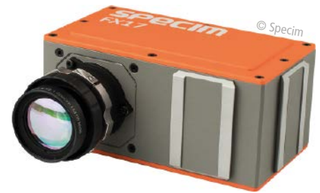
■ Abb. 3: Die Hyperspektralkameras Specim FX17 basieren auf einem InGaAs-Sensor und decken 224 Wellenlängenbänder im Nahinfrarotbereich (NIR) von 900 bis 1.700 nm ab. Viele der geschmacksbeeinflussenden Eigenschaften von Agrarprodukten können in diesem Spektrum untersucht und analysiert werden.
