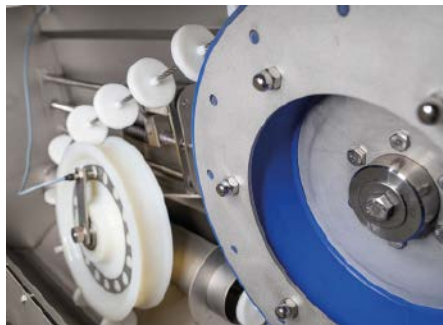
■ Abb. 3: Der Reibradantrieb und die Umlenkrollen der Seilförderer sind sehr wartungsarm.
