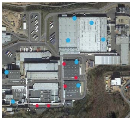
■ Abb. 2: Im ersten Schritt (linke Bildhälfte) werden mögliche Wärmequellen (rot) und Wärmesenken (blau) identifiziert. Die rechte Bildhälfte zeigt: Anhand des Durchmessers der Punkte kann darauf geschlossen werden, wie groß das Nutzungspotenzial als Wärmequelle oder -senke ist. Einige Punkte sind größer als links im Bild und haben sich als erschließbare Optionen mit attraktivem Potenzial qualifiziert. Andere Punkte sind kleiner und nicht nutzbar.
