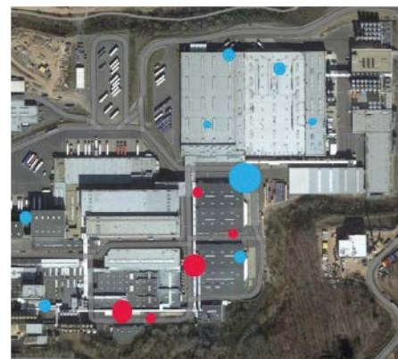
■ Abb. 2: Im ersten Schritt (linke Bildhälfte) werden mögliche Wärmequellen (rot) und Wärmesenken (blau) identifiziert. Die rechte Bildhälfte zeigt: Anhand des Durchmessers der Punkte kann darauf geschlossen werden, wie groß das Nutzungspotenzial als Wärmequelle oder -senke ist. Einige Punkte sind größer als links im Bild und haben sich als erschließbare Optionen mit attraktivem Potenzial qualifiziert. Andere Punkte sind kleiner und nicht nutzbar.
