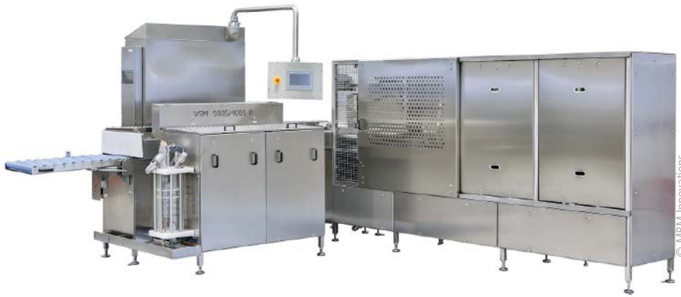
■ Abb. 2: Kern der Lösung sind die bewährten VSM Vakuum-Verpackungsmaschinen (im Bild die VSM 5005) von MBM Innovations sowie Pack-Age, eine neuartige, hoch-performante Reifemembran von DSM-Firmenich.
