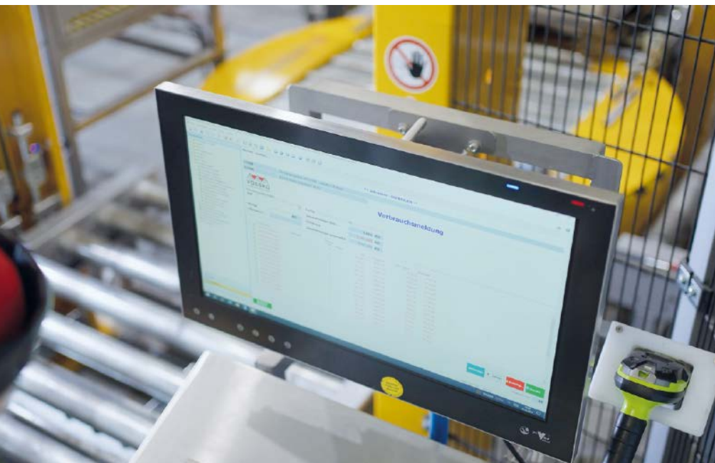
■ Abb. 1: Die Edelstahl-IPCs der Serie Pro-V-Pad Steel IP69k sind in einem hygieneorientierten und produktsicheren Design ausgelegt.
