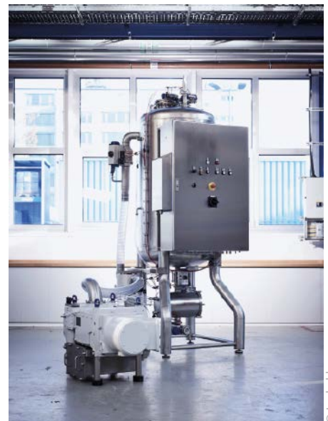
Abb. 3: Das BBVS (Beer Bottling Vacuum System) ist eine schlüsselfertige Komplettlösung zum Ersatz alter Flüssigkeitsringpumpen-Technologie.
