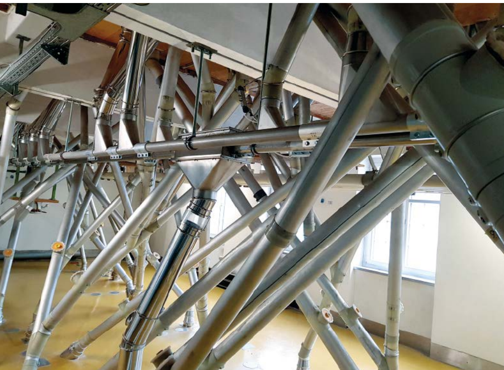
■ Abb. 1: Die Seilförderer von Wessjohann sind sehr flexibel und lassen sich auch an komplizierte räumliche Gegebenheiten anpassen.
