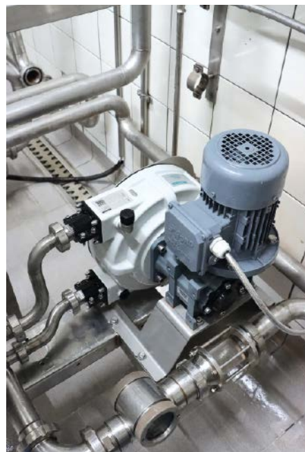
■ Abb. 3: Für die Förderung der Kieselgur-Suspension im Brauprozess nutzt Müllerbräu nun eine Peripro Schlauchpumpe in Lebensmittelausführung von Netzsch.
